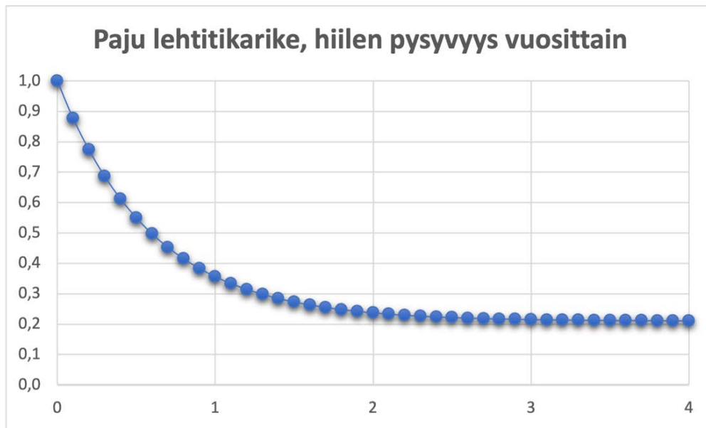
Kuva 6. Pajun lehtitikkariikkeen alkuainehiilen pysyvyyskerroin neljän vuoden aikana, Ruotsin mittausten mukaan (viite: Rytter 2001, 2012, 2015)
